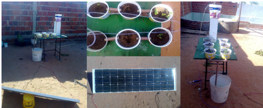
Figura 3 – Aparato real do kit didático com Sistema Fotovoltaico de Bombeamento
