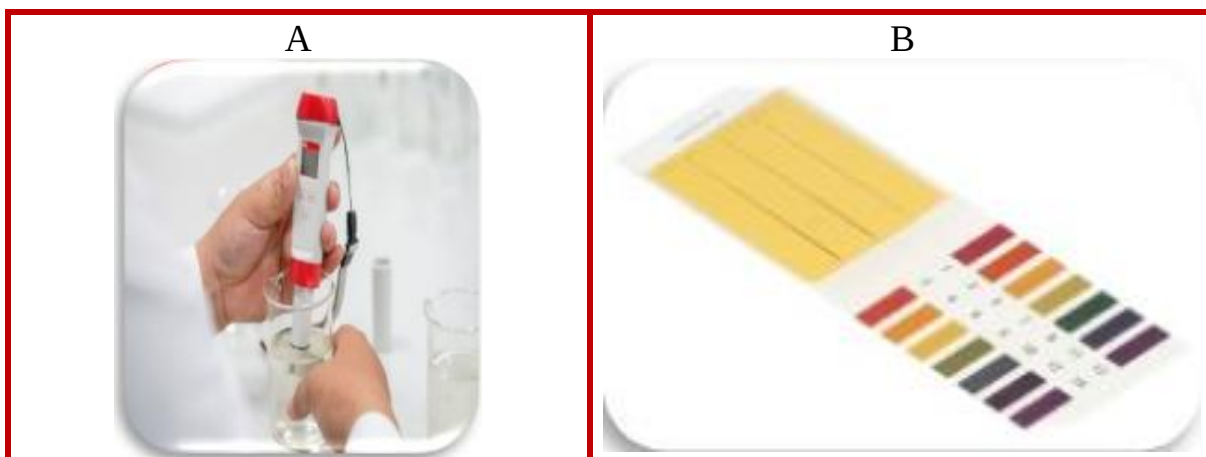
Figura 13 – A) avaliando a condutividade elétrica da água e B) frita de medir pH da água e outras soluções.
