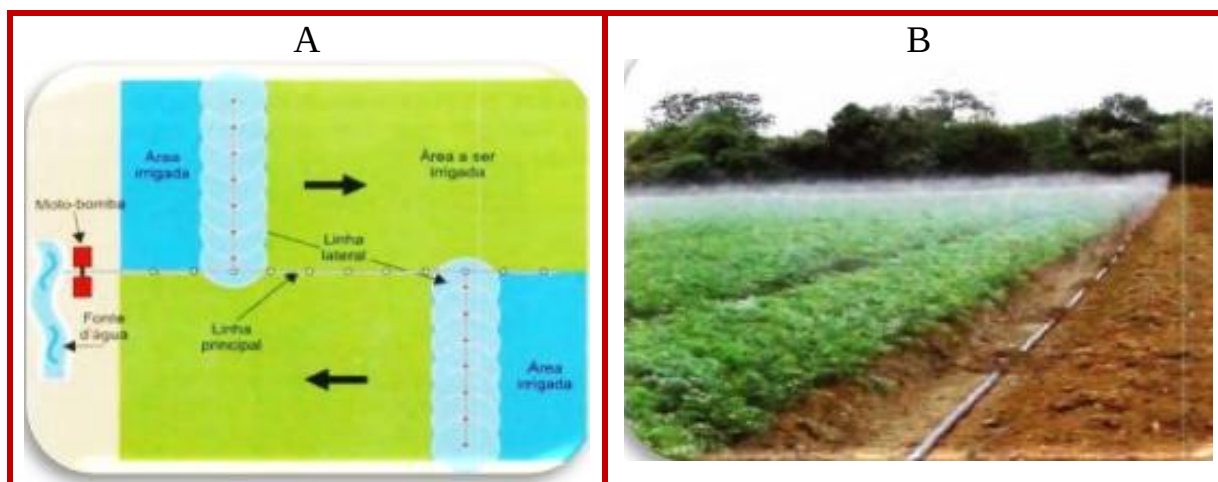
Figura 3 – Sistema de irrigação por aspersão convencional com tubos perfurados, em lavoura de cenoura.
