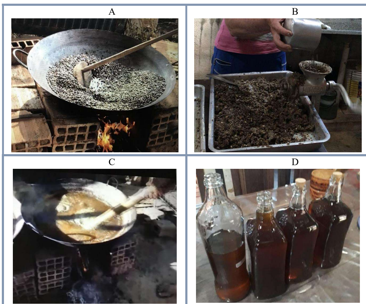
Figura 1- Etapas no processo de extração do óleo de rícino ou azeite de mamona pelo cozimento: A) sementes de mamona sendo toradas; B) moendo as sementes; C) cozimento das sementes moídas e D) azeite de mamona apurado. Fotos: Marlei Rosa dos Santos
