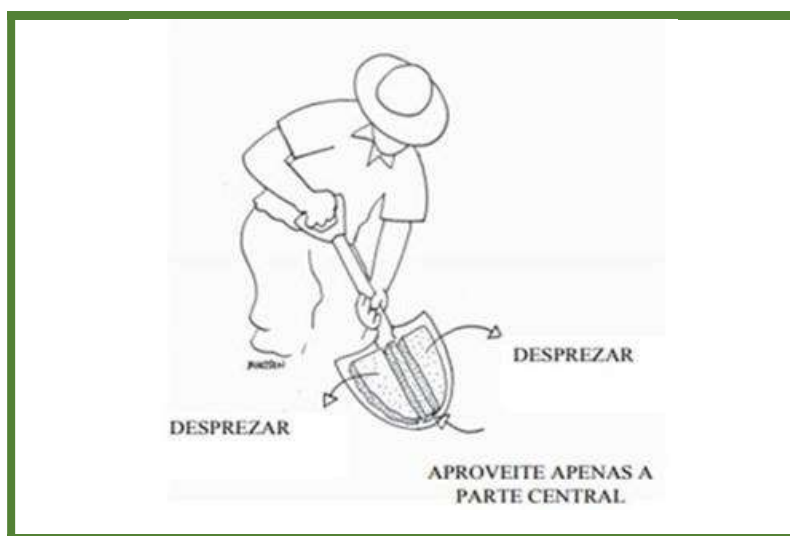
Figura 7 - Amostragem realizada com pá para escavação. Fonte: Biratan Porto (2003), citado por Silva (2018).
