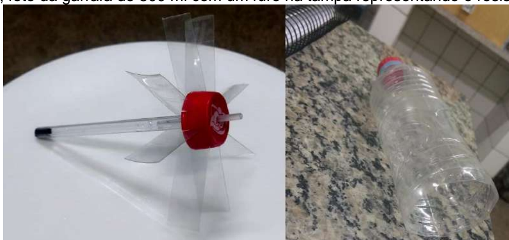
Figura 4 – À esquerda, foto do moinho caseiro representando um motor elétrico, à direita, foto da garrafa de 500 ml com um furo na tampa representando o resistor. 7
