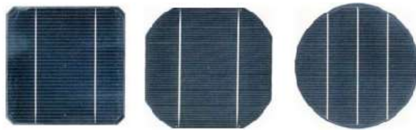
Figura 26 – Células de Silício monocristalino e policristalino
