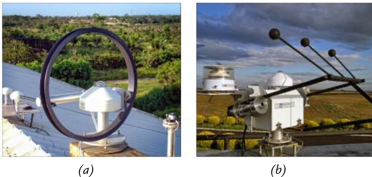
Figura 9 – Piranômetro termoeletrico com sombreamento
